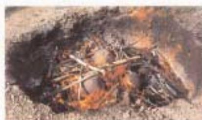
b. 11:47 Uhr, 320°C: Auch über dem Gefässen liegt Brennstoff. Temperatur steigt schnell.
