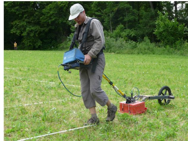
Auf der Suche nach archäologischen Fundstellen kommen Verfahren zum Einsatz, bei denen nicht gegraben wird. Hier wird der Bodenradar verwendet, um den Standort eines mittelalterlichen Turmes zu suchen.
